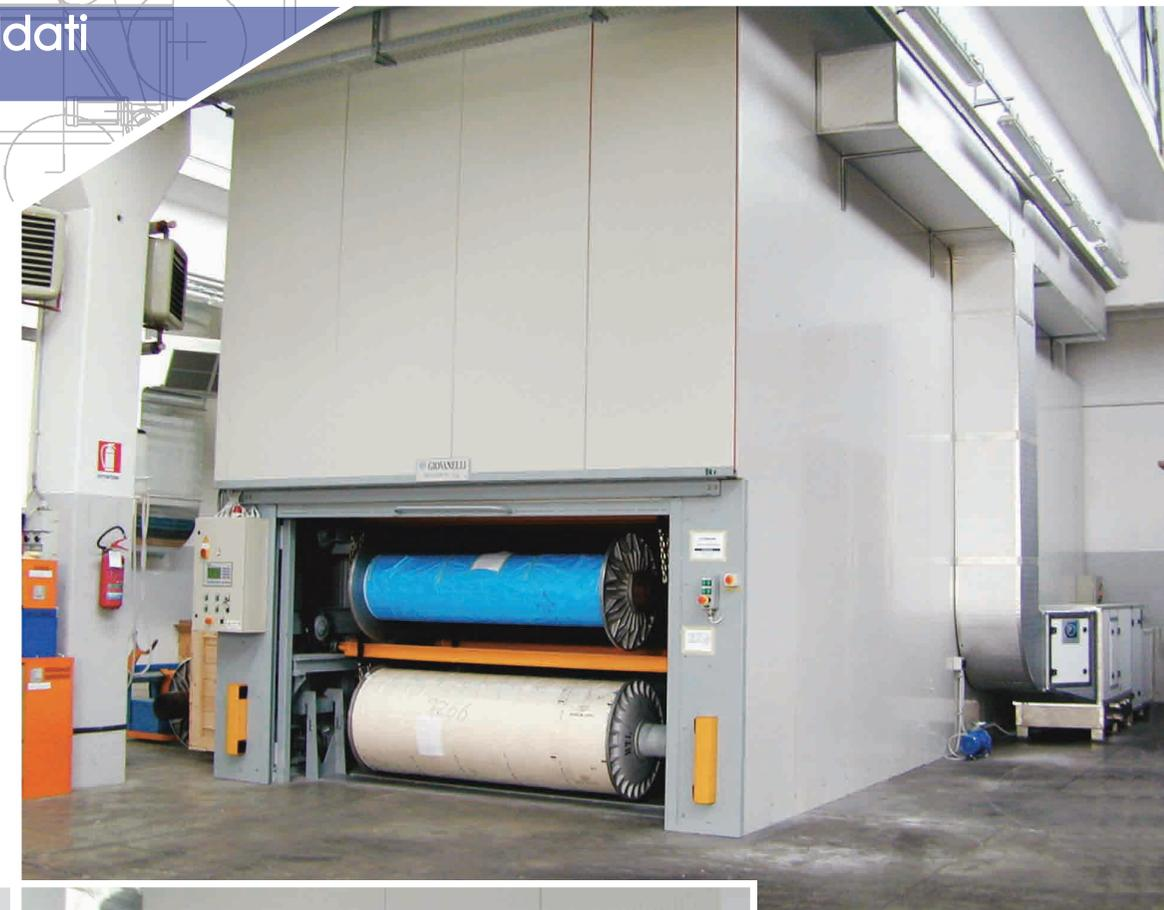
Si possono **chiudere e climatizzare** per conservare il prodotto a temperatura e umidità richieste. Viene utilizzato anche per il processo di **vulcanizzazione** dei prodotti immagazzinati
