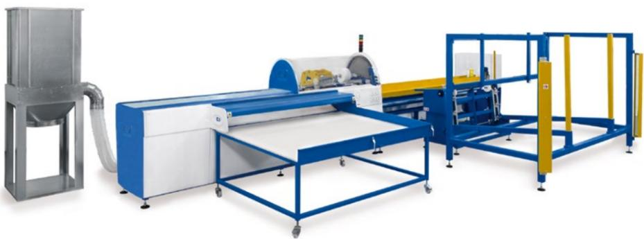
DIAMETRI DA 3" A 6" / STESSA LAMA PER TUTTI I MATERIALI / NESSUN INTERVENTO MECCANICO / SISTEMA DI ASPIRAZIONE INTEGRATO / CARICO DI SPEZZONI MANUALE / COMANDI TOUCH
